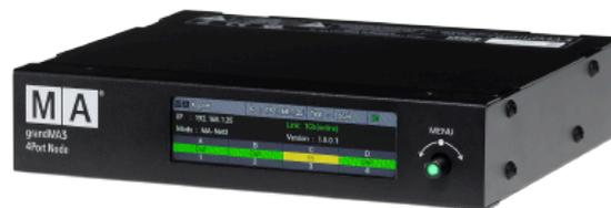
Der grandMA3 4Port Node ist ein leistungsstarker Konverter, um Netzwerk Daten in DMX umzuwandeln. Der in einem 8"/1HE Gehäuse verbaute Node gibt vier synchronisierte DMX-Universen aus jeder grandMA3 Session aus und ist sowohl für Touring als auch Festinstallationen bestens geeignet. Das einzigartige Halterungszubehör ermöglicht bei Bedarf vielfältige Befestigungsmöglichkeiten.
