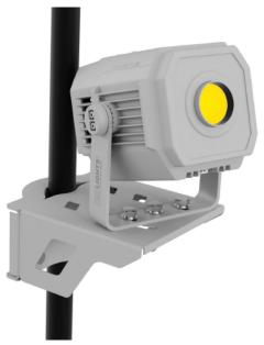
Die Halterung für den Mosaico JR ist für die Wandmontage und Aufhängung an Masten mit quadratischem Querschnitt mit einem Durchmesser von 50x50mm bis 150x150mm oder mit rundem Querschnitt mit einem Durchmesser von 50mm bis 150mm.
