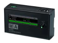
Bist Du auf der Suche nach einem DMX-Node für Dein Theater, TV-Studio, Gotteshaus oder eine andere Installation? Die grandMA3 onPC xPort Nodes DIN-Rail sind die perfekte Lösung für Dich! Die Nodes erfüllen zwei verschiedene Aufgaben: Sie konvertieren Ethernet-Daten in DMX, und sie können Parameter zu Deinem grandMA3 onPC System hinzufügen.
