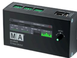
Der grandMA3 I/O Node DIN-Rail ist das Multitool der Signalverteilung innerhalb eines grandMA3 Systems, insbesondere für Festinstallationen. Wo auch immer das Signal generiert oder benötigt wird - platzieren Sie dort einfach einen grandMA3 I/O Node DIN-Rail und empfangen oder senden Sie externe Signale.
