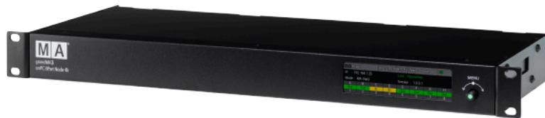
Was brauchen wir, um echte Geräte zu steuern? DMX-Ausgänge! Hier kommen die grandMA3 onPC xPort Nodes ins Spiel. Die Nodes erfüllen zwei verschiedene Aufgaben: Sie konvertieren Ethernet-Daten in DMX, und sie können Parameter zu Deinem grandMA3 onPC System hinzufügen. Lade also einfach die grandMA3 onPC Software herunter, schließe einen grandMA3 onPC xPort Node an und schon kannst Du Deine Fixtures steuern!
