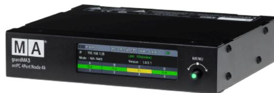
Was brauchen wir, um echte Geräte zu steuern? DMX-Ausgänge! Hier kommen die grandMA3 onPC xPort Nodes ins Spiel. Die Nodes erfüllen zwei verschiedene Aufgaben: Sie konvertieren Ethernet-Daten in DMX, und sie können Parameter zu Deinem grandMA3 onPC System hinzufügen. Lade also einfach die grandMA3 onPC Software herunter, schließe einen grandMA3 onPC xPort Node an und schon kannst Du Deine Fixtures steuern!
