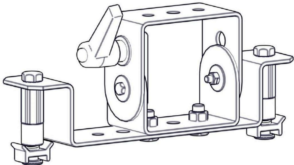
Für ein optimales Handling der Dalis 860, ist der Einsatz von zwei Mini-Bügeln pro Gerät zu empfehlen.
