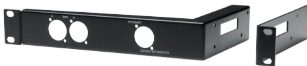
Das MA 2Port Node 19" Rack Einbau Kit mit Blende für XLR Anschlüsse ermöglicht den einfachen und fachgerechten Einbau eines MA 2Port Node in einen 19" Schrank speziell in Festinstallations. Durch die Blende für XLR Anschlüsse lassen sich alle rückseitigen DMX- und Ethernetanschlüsse nach vorne legen.
